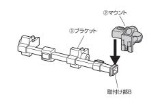
(4)ブラケットのノブを回してクランプを開きます。 (5)クランプをシャフトの幅に合わせ取付けます。 (6)ノブを回してシャフトにブラケットを固定します。
