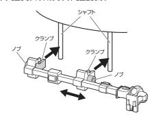
(7)マウントにホルダーを取付けます。 ※マウント裏面のロック解除レバーを持ち上げてホルダーを取外すことができます。
