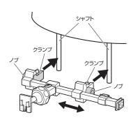
(5)マウントにホルダーを取付けます。 ※マウント裏面のロック解除レバーを持ち上げてホルダーを取外すことができます。
