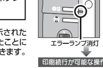
\*印刷中のステータスマニターには(×)が表示されたままであります、リセットボタンを操作したことによりエラーが解消されたので、印刷が続行できます。
