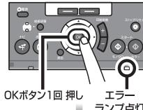
※①の液晶モニターには(×)が表示されたままでが、OKボタンの操作によりエラーが解消されたので、印刷が続行できます。
