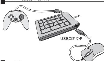
本製品には、USBマウス、USBラッシュディスク、USBジョイスティック、USBゲームパッド、ワイヤレスマウス・キーボードの受信機などのUSB機器を接続して使用することができます。USB機器の接続については各機器の取扱説明書を参照してください。
