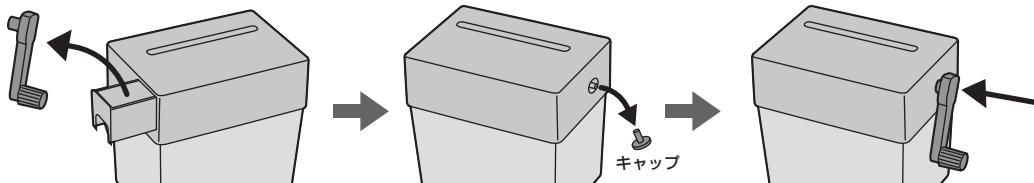
②投入口の中央に垂直に細断する物を入れます。本体をしっかりと押させて、ハンドルを右回りに回して細断します。
