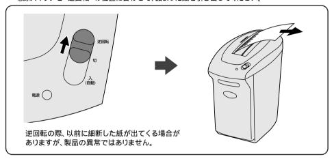
**2.**電源スイッチを"入(自動)"の位置に合わせ、紙の量を規定枚数以下に減らして、 細断した逆側の方向から用紙投入口にまっすぐに入れてください。
